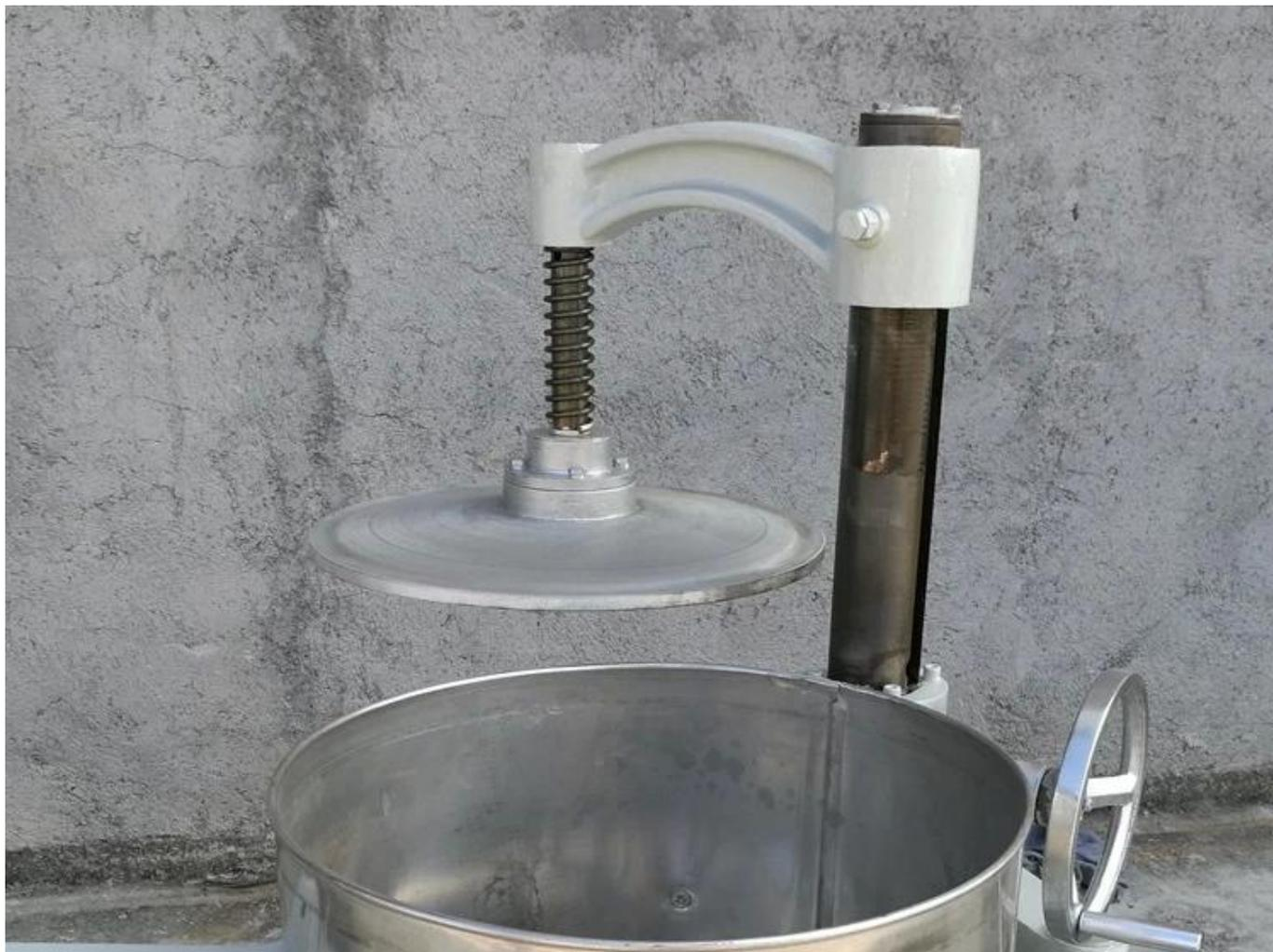
Конструкция с наклонным отверстием для винтового стержня, крышка ствола автоматически поворачивается, когда она поднимается вверх, повышая эффективность.
