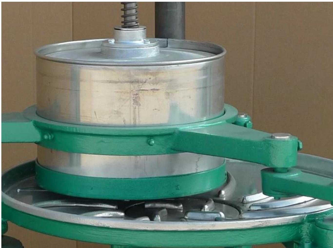
Расстояние между барабаном и роликовым диском каждой машины разное, чтобы каждая машина могла приготовить чай самого высокого качества.
