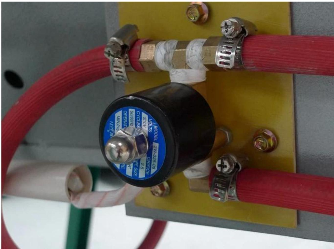
Конструкция с автоматическим электромагнитным клапаном, нагрев автоматически запускается и останавливается, электромагнитный клапан автоматически закрывается, когда температура достигает заданной температуры, и машина прекращает нагрев. Когда температура ниже установленной, электромагнитный клапан открывается, и машина повторно нагревается, что позволяет сэкономить топливо.
