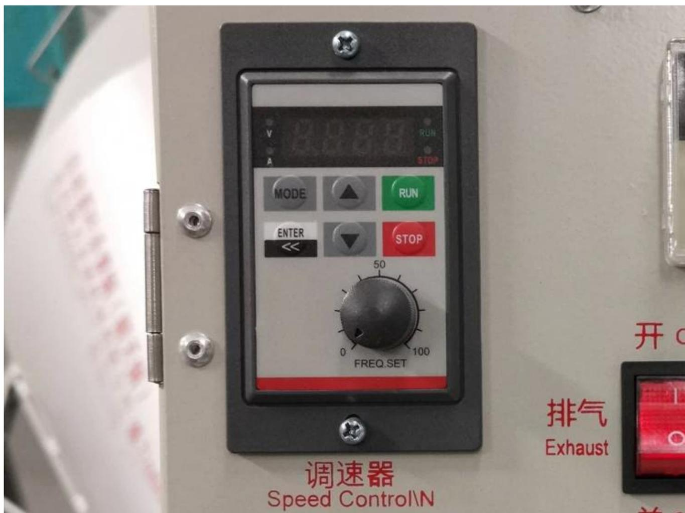
Скорость машины для фиксации чая можно регулировать, в зависимости от чая в разных зонах производства, можно регулировать разную скорость
