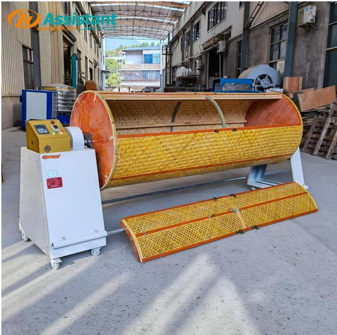
Конструкция из стальной трубы и стального кольца, машина работает плавно, а вибрация корпуса небольшая.
