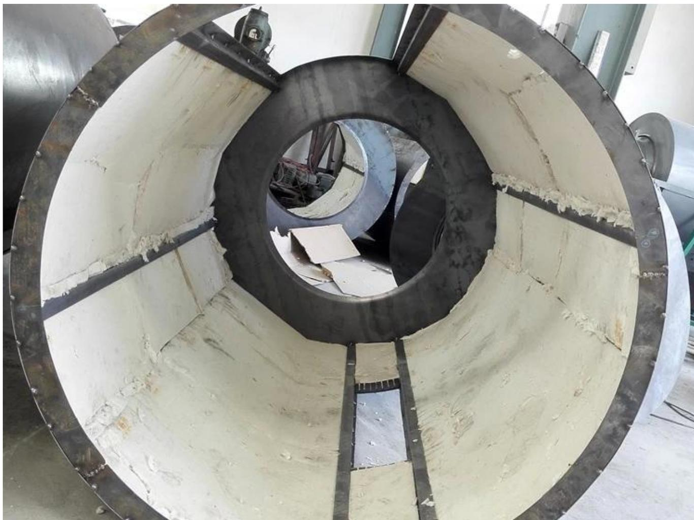
Во внутреннем корпусе используется новый тип экологически чистого огнестойкого изоляционного материала толщиной до 20 мм, который значительно снижает потери тепла и экономит энергию на 30%.
