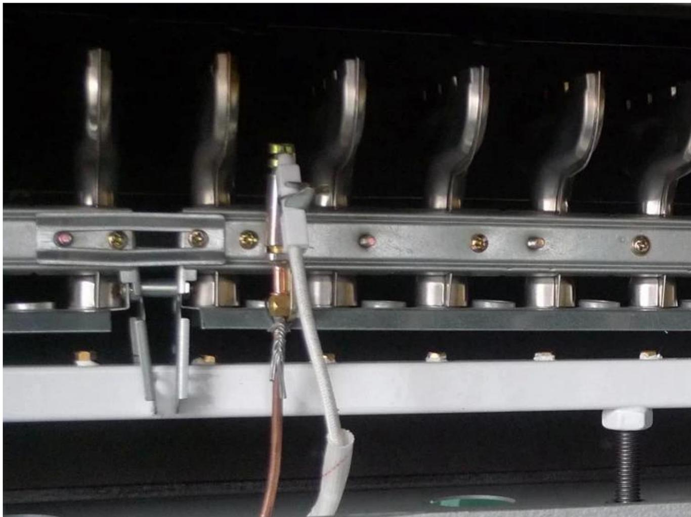
Сохраните конструкцию головки сгорания постоянного пламени, сохраните постоянное пламя горения после успешного розжига, повторно воспользуйтесь пламенем постоянного горения, уменьшите давление иглы зажигания и катушки зажигания и увеличьте срок службы .
