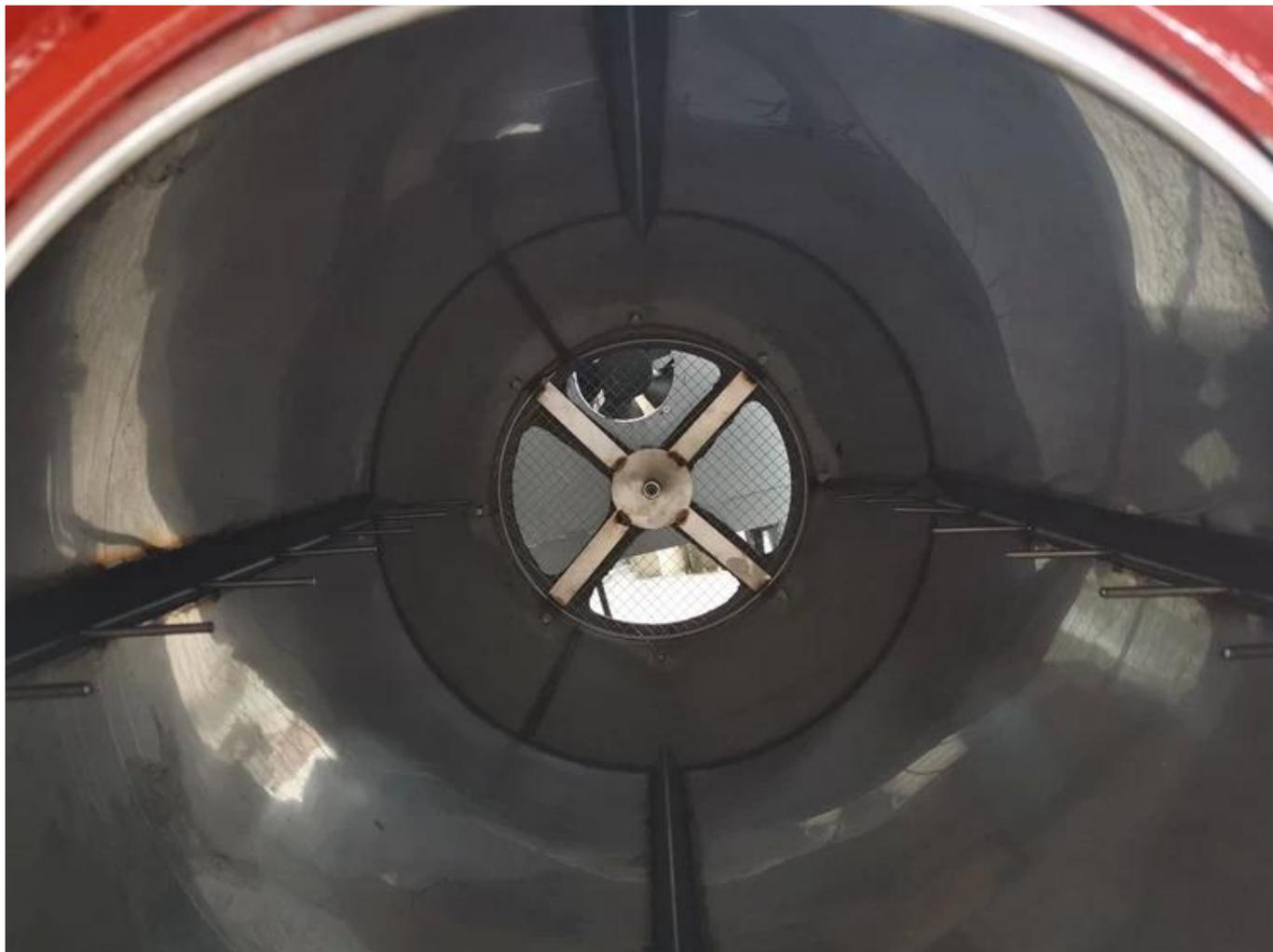
Используя сверхтолстую стальную пластину 2,5 мм, изменение температуры небольшое и хорошее сохранение тепла, чайный лист не будет поврежден (другие фабрики используют только стальную пластину 1,6 мм)
